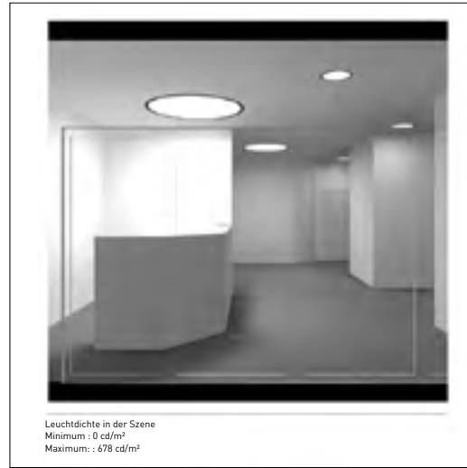
Abbildung: 3D-Leuchtdichte, Ansicht von vorne Rezeption / Flur
